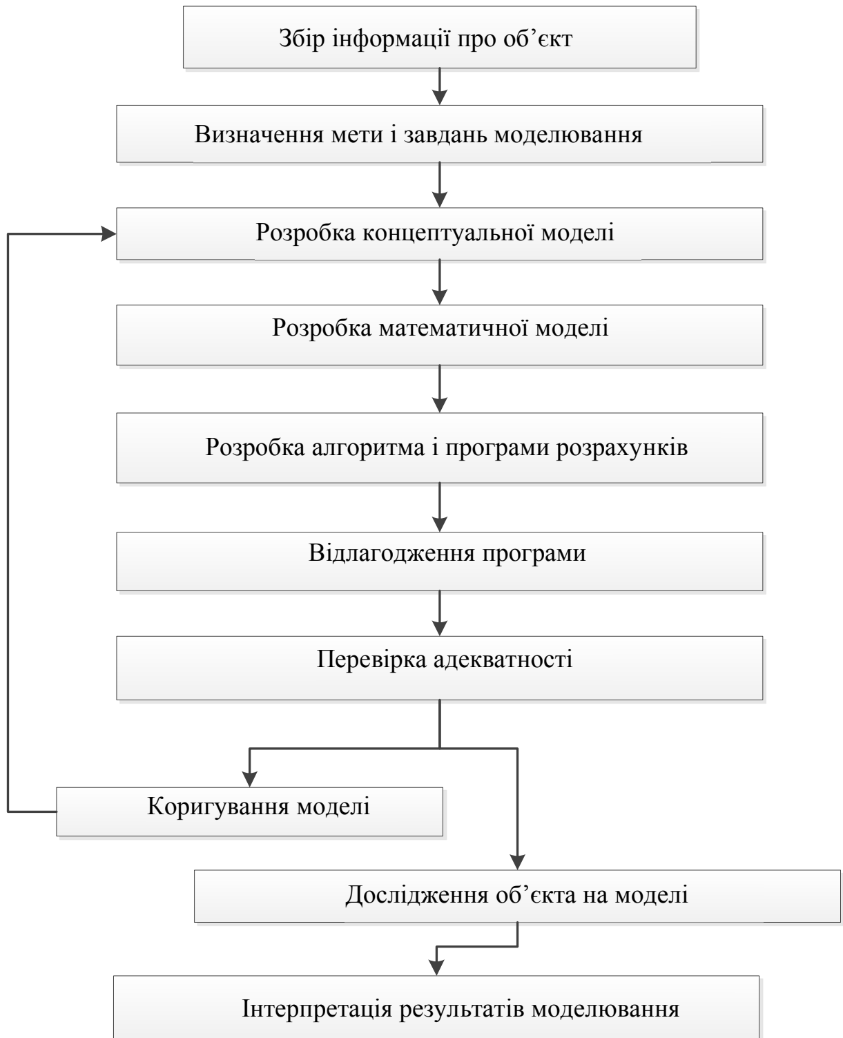
Рисунок 2. - Етапи комп'ютерного математичного моделювання об'єкта
