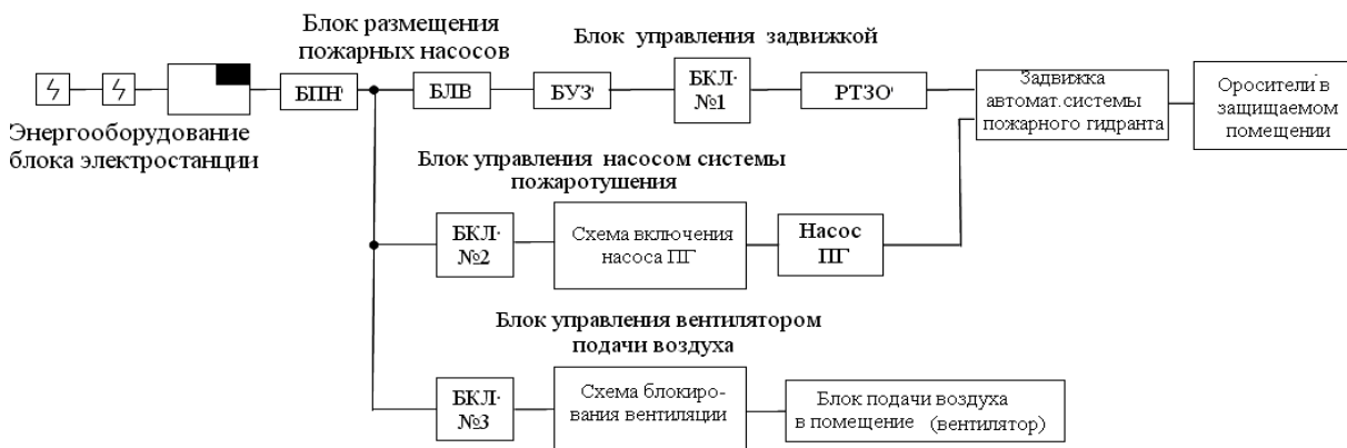
Рисунок 1 – Функциональная схема существующей автоматической установки обнаружения и тушения пожаров в машинном зале
