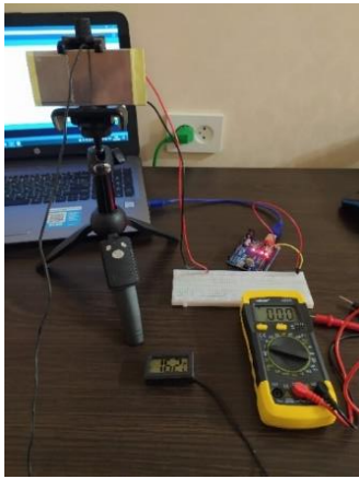
Рисунок 1 - Модель пристрою осушення повітря в закладах охорони здоров'я
