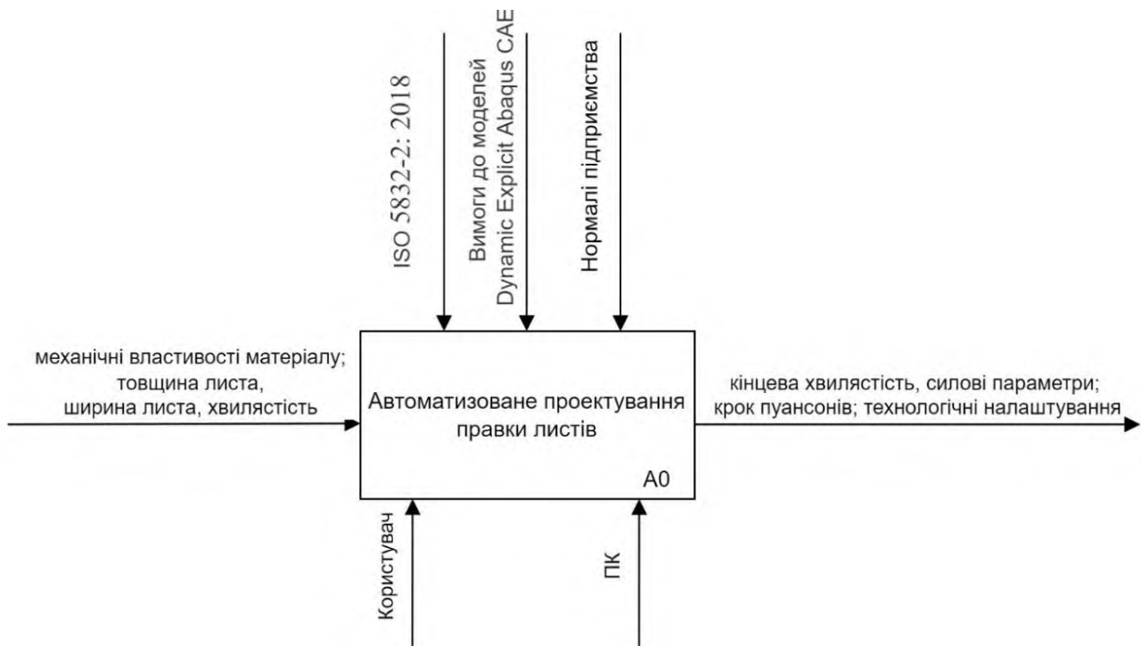
Рисунок 2 – Структурно-функціональна діаграма 0-го рівня автоматизованого проектування конструктивних параметрів листопривального пресу
