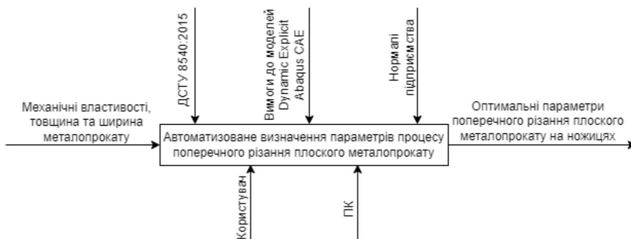
Рисунок 1 – Структурно-функціональна діаграма нульового рівня процесу автоматизованого визначення оптимальних параметрів поперечного різання плоского металопрокату на ножицях
