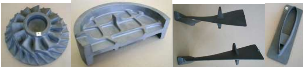
Рисунок 7.4 – Деталі, що виготовлені ізотермічним штампуванням
