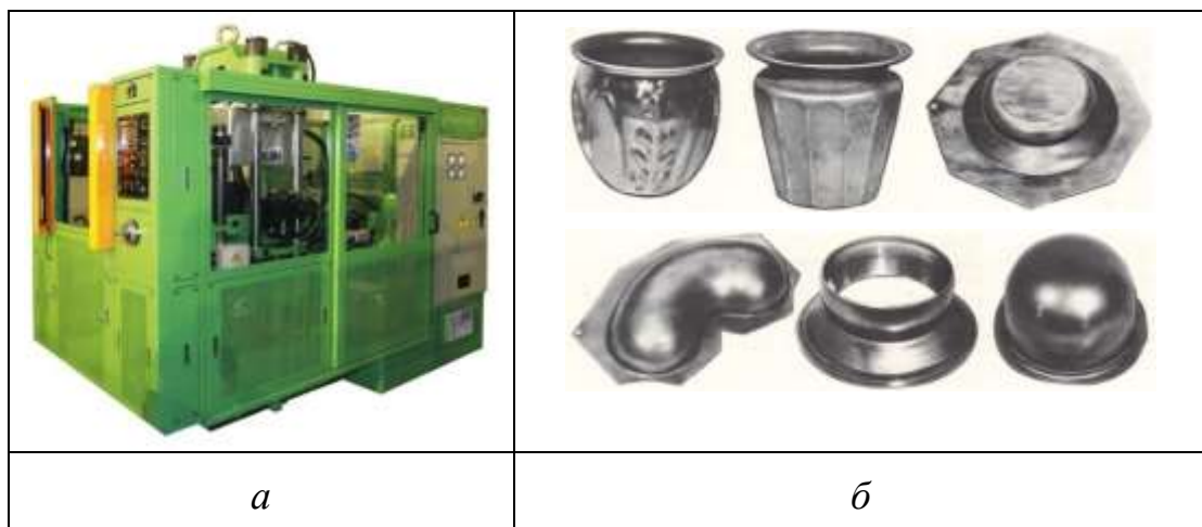
Рисунок 6.6 – Прес для електрогідроімпульсного штампування (а) і отримані деталі (б)
