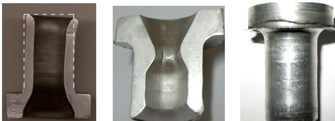
Рис. 4.8. Дефекти у вигляді викривлення відростка і складок у процесі радіально-прямого видавлювання з обтисненням
