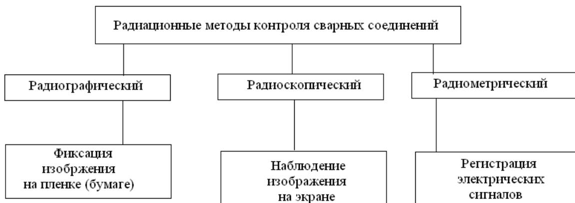
Рисунок 4.21 – Методы радиационной дефектоскопии
