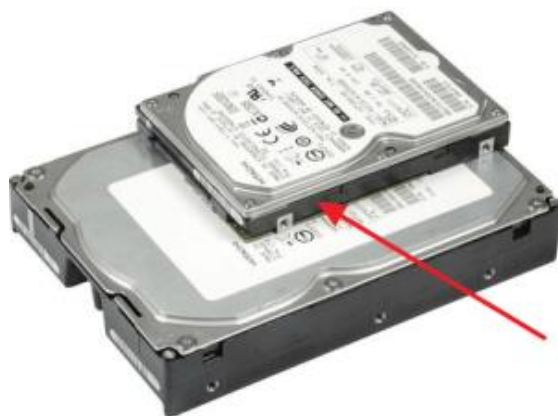
Рисунок 1.37 – Різниця в розмірах між 2,5 і 3,5-дюймовими жорсткими дисками
