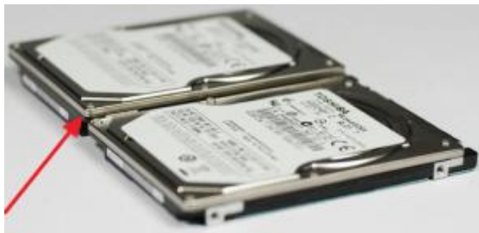
Рисунок 1.39 – Різниця в товщині між різними 2,5-дюймовими жорсткими дисками
