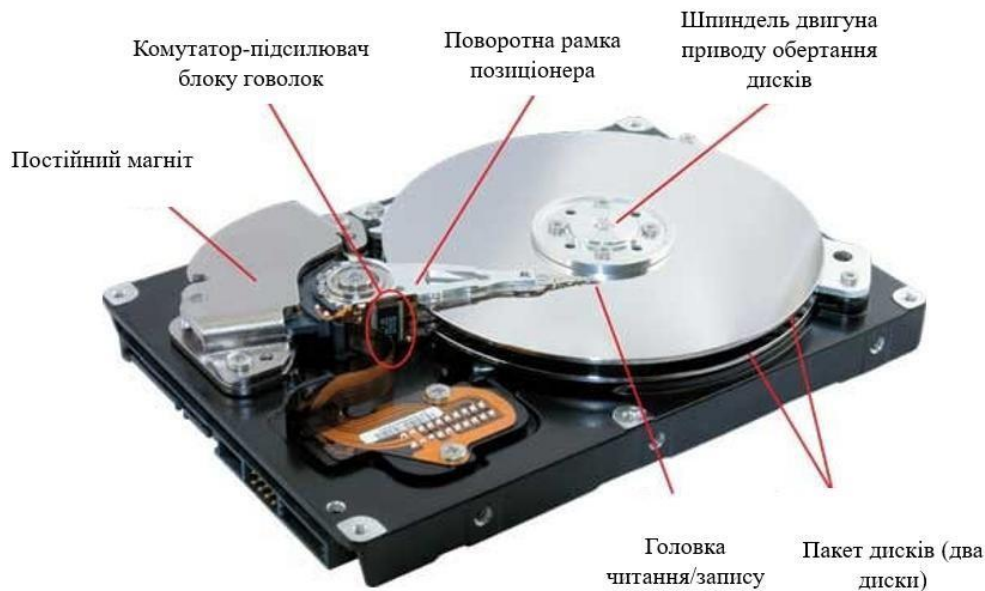
Рисунок 1.32 – Будова жорсткого диска
