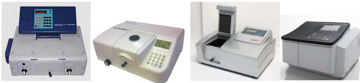
а) б) в) г) а – фотоколориметр КФК-2МП; б – фотометр КФК-3-01; в – спектрофотометр ЮНІКО-2100 (однопроменевий); г – спектрофотометр UV-1800, Шімадзу (двопроменевий) Рисунок 2.13 — Фотоелектричні прилади для вимірювання світлопоглинання
