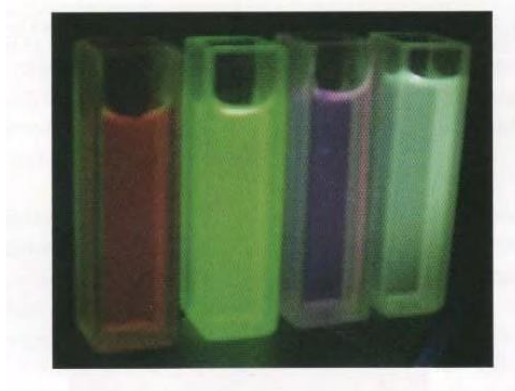
Рисунок 2.30 – Люмінесценція водних розчинів комплексів європію, тербію, диспрозію і самарію при УФ-опроміненні світлом довжиною хвилі 365 нм
