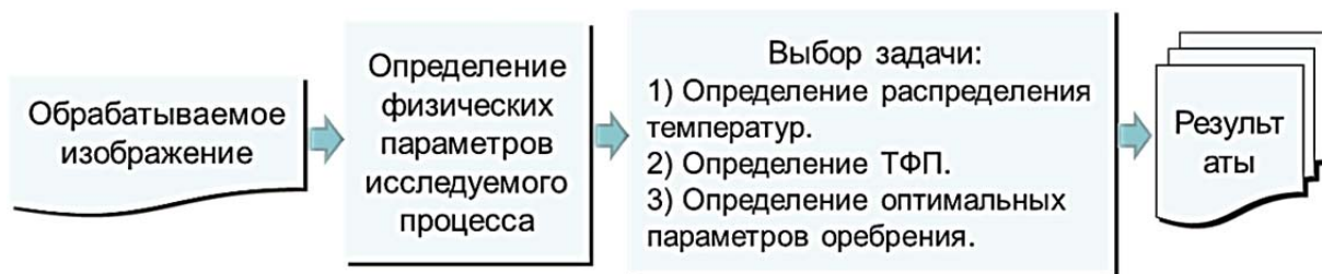
Рисунок 1 – Общая структура информационной технологии расчета теплофизических параметров процесса по его изображению
