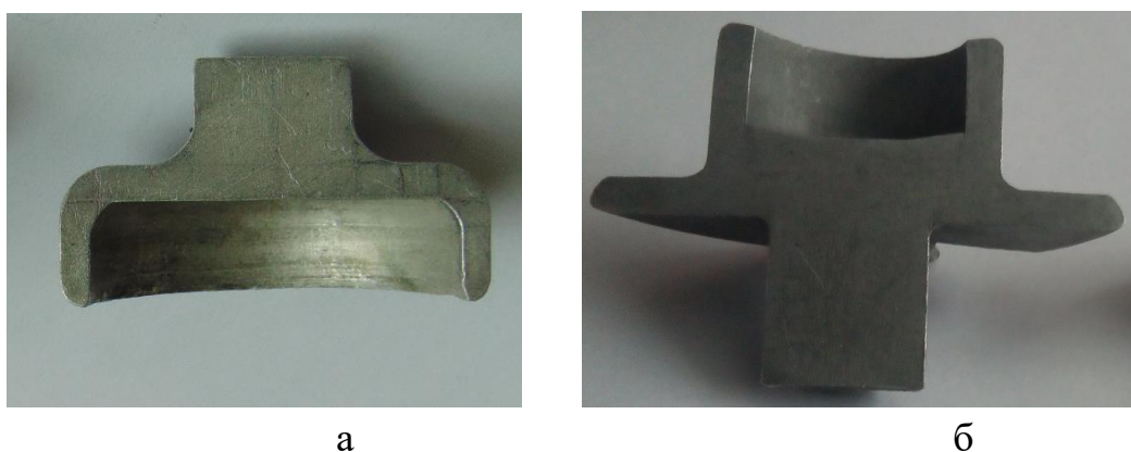
Рис. 3.6 – Отримані деталі з наявністю заокруглень при послідовному радіально-прямому видавлюванні з роздаванням (а) та комбінованому радіально-поздовжньому видавлюванні з декількома ступенями свободи течії (б)
