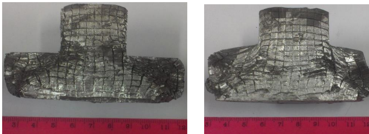
Рис. 4.30 - Зразки деталей, отриманих комбінованим осадженням
