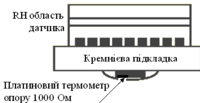
Рисунок 2.3 – Структура датчика вологості з убудованим платиновим датчиком температури
